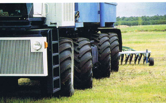
In der Hundegangschaltung verlaufen die Fahrspuren der acht Räder parallel nebeneinander.
